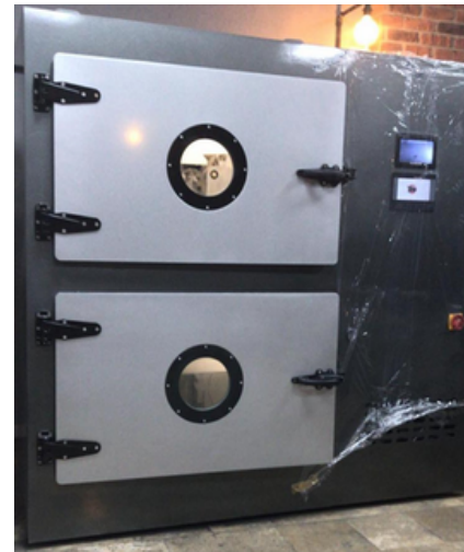
Makine: Vakum PU Döküm Makinesi Döküm Kapasitesi: 1,5 kg
